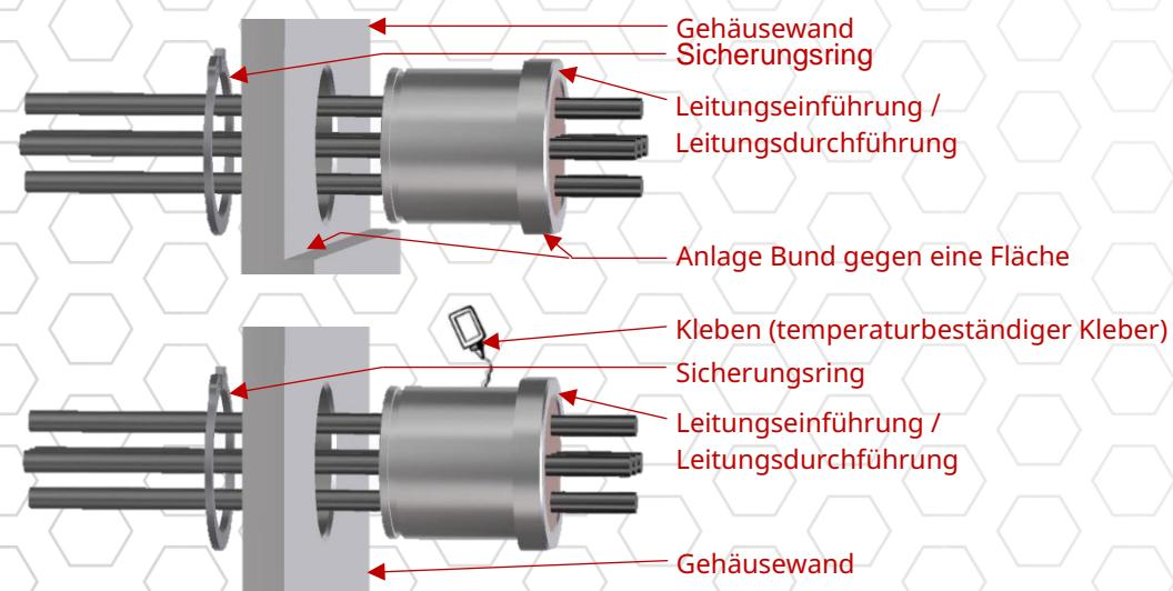
Sicherungsmöglichkeiten beim Einbau mit Sicherungsring DIN 472 (für Bohrung):
